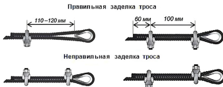
Рисунок 6 – Заделка троса
